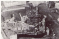
Bild 120 Der Aus- und Einbau der beiden Getriebewellen erfolgt immer gleichzeitig/gleichmässig
