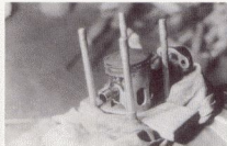
Bild 93 Ein «Gabelbrettchen» stützt den Kolben bei den Montagearbeiten sicher ab
