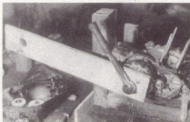
Bild 104 Selbstgebafter Gegenhalter für die Kupplungsnaabe. An seiner linken Seite passt er zur Kupplung der Modelle SR 500 und XT 500.
