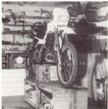
Bild 50 4 Einzelelemente, wie hier zusammengestellt, bilden eine Montagebühne
