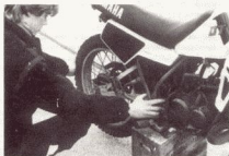
Bild 18 Prüfen der Schwingenlager
